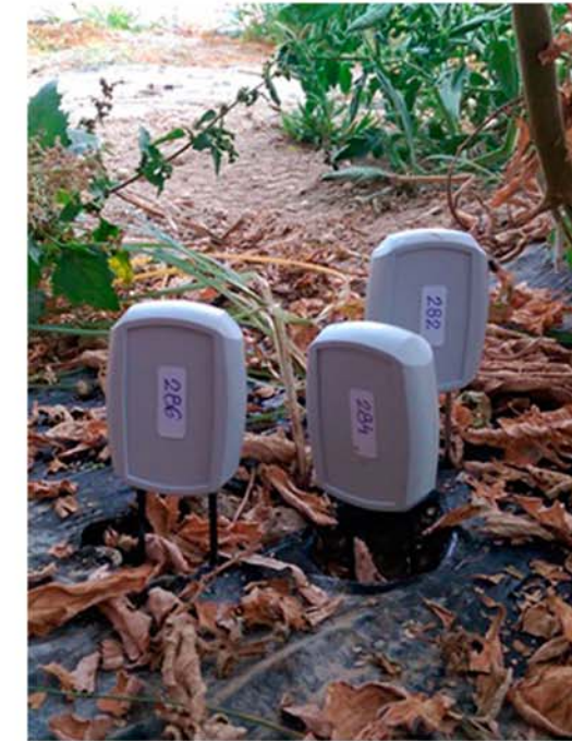
2.- Sensores de humedad.
