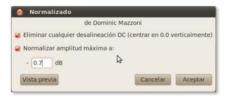
Fijamos un valor para la amplitud máxima (entre 0 y 1) y pulsamos en vista
